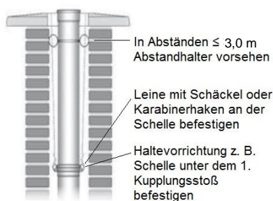
Abbildung 9: Rohrelemente im Schacht ablassen
