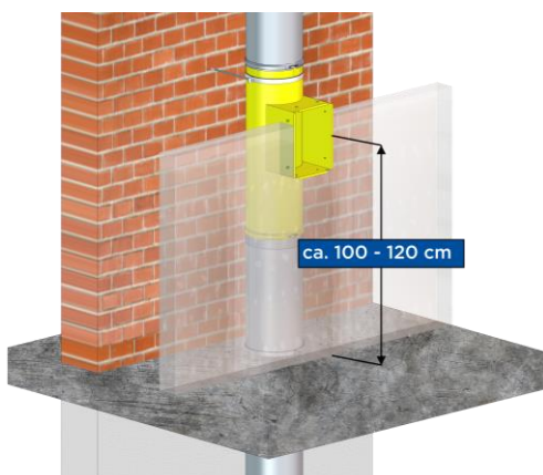
Bild 5-20: Höhe der Einwurfschächte über Fertigfußboden
