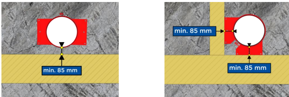
Bild 5-11: Wandabstände Konsolen im Rohbau
