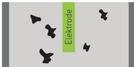
1. Feinstaubpartikel strömen mit der Abluft durch den Abgaskanal.
